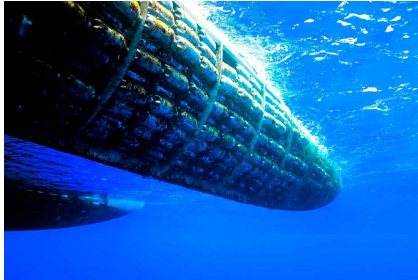
garrafas presas ao casco. Em cada garrafa foi colocado gelo seco, e, após bem vedada, foi aquecida. O gelo seco libertou dióxido de carbono, deixando o recipiente rígido. As garrafas foram dispostas numa grelha para formar os dois cascos; estas garantem que a estrutura não afunde na água.
