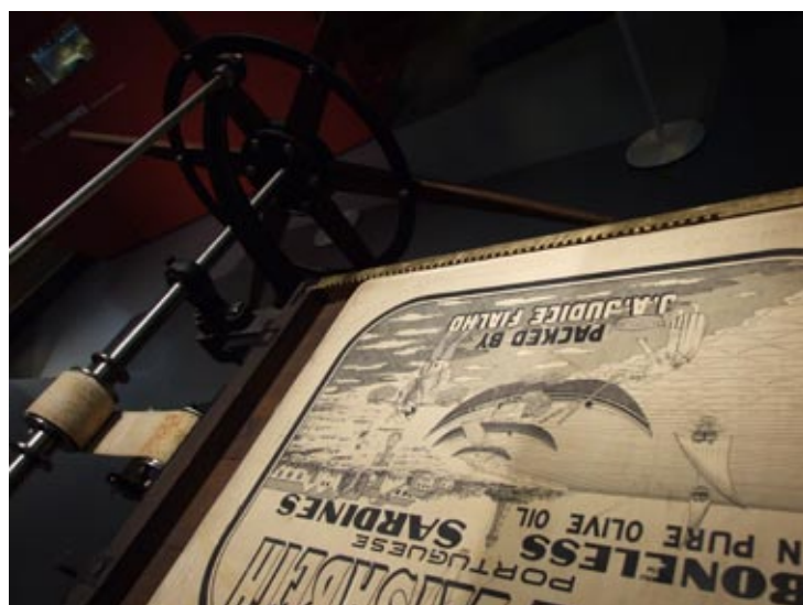
Prensa para o processo litográfico, usada na indústria da conserva do peixe. Museu de Portimão.
